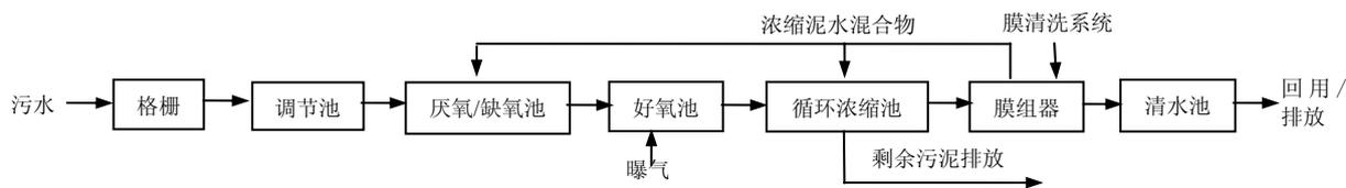
图 4 外置式膜生物法工艺流程图
