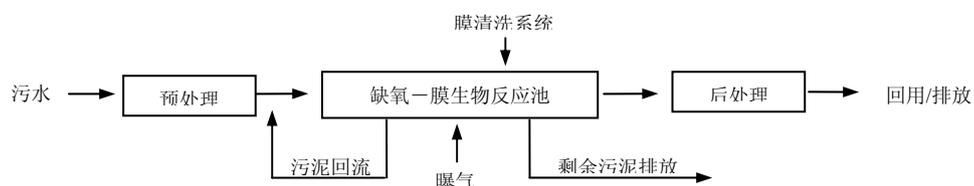
图 2 以脱氮为主的膜生物法工艺流程图
